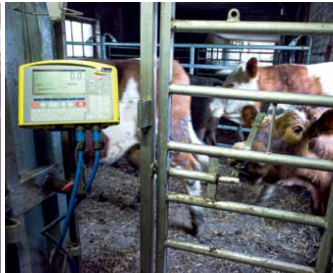
Naudojant elektroninio ženklavimo sistemą, gyvulio duomenys nuskaitomi ir greitai perduodami į duomenų bazę.
