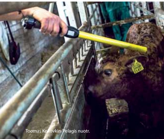
Naudojant elektroninio ženklavimo sistemą, gyvulio duomenys nuskaitomi ir greitai perduodami į duomenų bazę.
