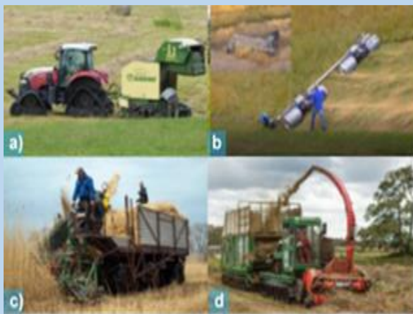
Ūkininkauti šlapiuose buveinėse pritaikyta technika: a – standartiniai mažo svorio vikšriniai traktoriai ir žolės ritininiai presai (pvz., Delta Track modeliai); b – mažų gabaritų įranga, c – plačiaratis nendrių kombainas „Seiga“, d – plačiarikišė transporto priemonė (traktorius) su priekaba bei priekyje pritvirtintu smulkintuvu.
