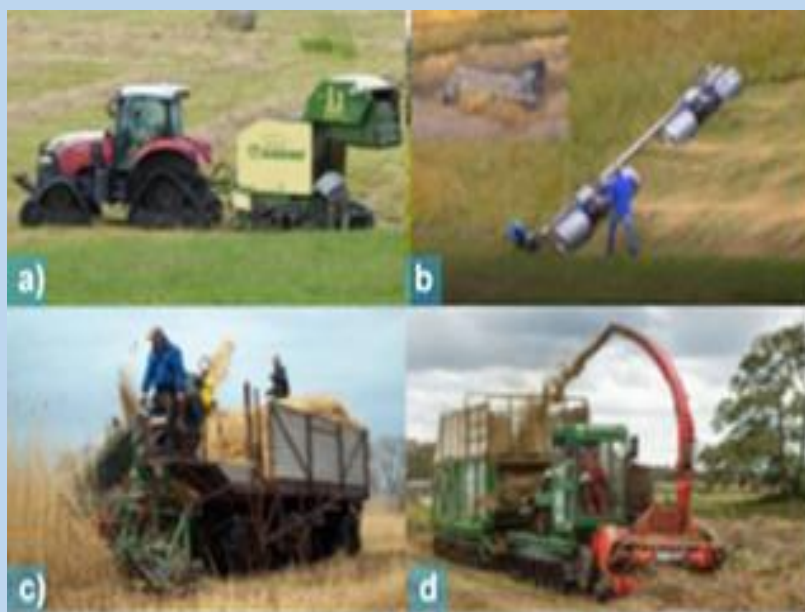
Ūkininkauti šlapiuose buveinėse pritaikyta technika: a – standartiniai mažo svorio vikšriniai traktoriai ir žolės ritiniai presai (pvz., Delta Track modeliai); b – mažų gabaritų įranga, c – plačiarikišis kombainas „Seiga“, d – plačiarikišė transporto priemonė (traktorius) su priekaba bei priekyje pritvirtintu smulkintuvu.
